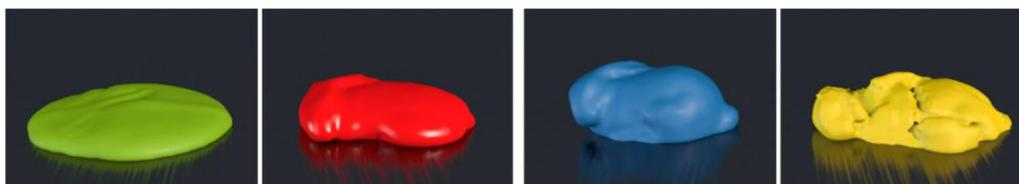
图 3-19 牛顿流体与非牛顿流体的对比。由左至右分别为低粘性牛顿流体、剪切增稠流体、高粘性流体、剪切变稀流体。
